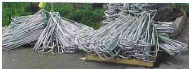
現場で貯蔵されている溶融亜鉛めっき鉄筋
